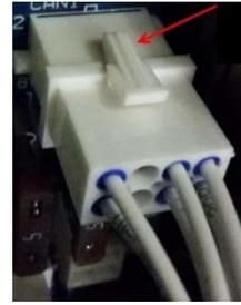
3. Puis, débranchez le bouchon à 8 pins Deutsch du faisceau de câbles LVD de la boîte de contrôle.
