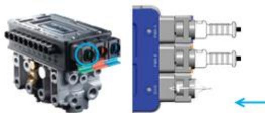
3. Tirez le verrouillage à glissière vert du système TEBS vers le bas et insérez le connecteur.
