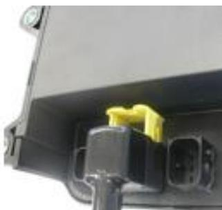
Grâce au concept du connecteur, vous ne brancherez pas de connecteur dans un port erroné.
