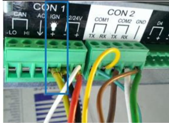
Le fil jaune d'IGN doit être connecté au fil « GCS-1/SPK2 », qui se trouve dans le boîtier électrique du frigorifique.
