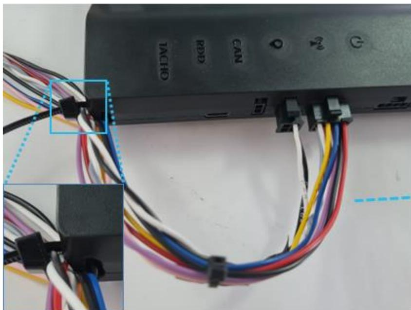
Come mostrato nell'esempio, controllare che non vi sia tensione sui connettori, formando un ampio occhiello con il cavo..
